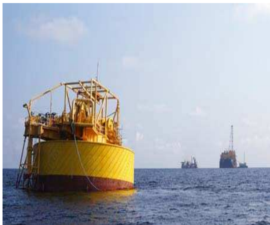
Figure 19: Bouée de chargement avec en arrière plan le FPSO
