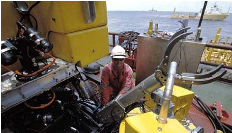
Figure 16: bras articulé du MATIS avec sa pince
